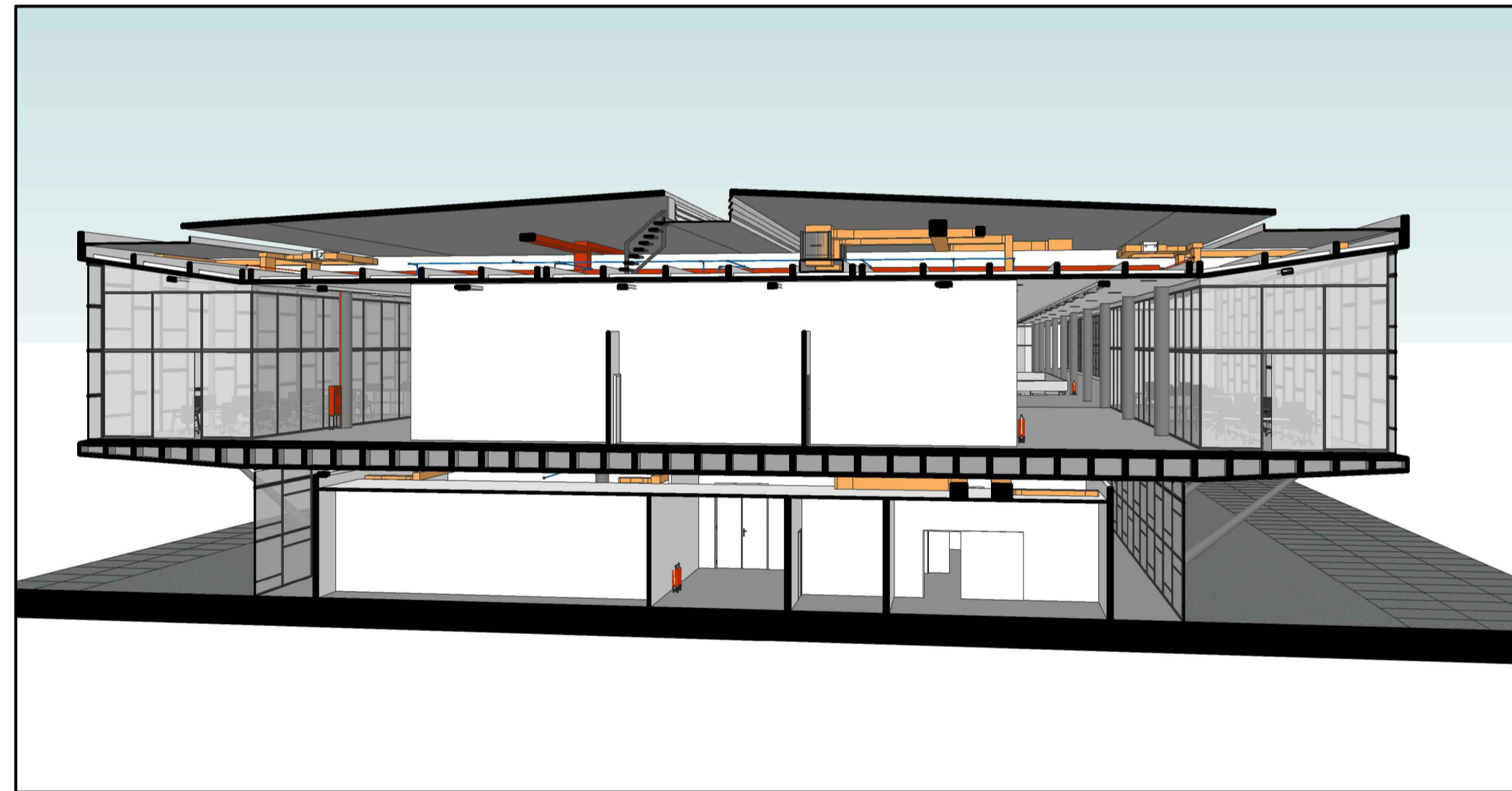
CORTE PERSPECTIVADO – ACESSO ÀS CALHAS TÉCNICA/PASSARELA
