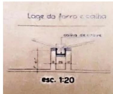
**Figuras 11 e 12** – Detalhes do sistema de condução de águas pluviais do Pavilhão das Nações. Coleção dos projetos do IV Centenário localizado no Arquivo Público Municipal.
