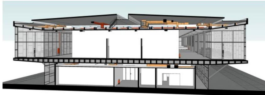
**Figura 20** – Imagem do Modelo com vista da escada de acesso à calha técnica e calha passarela.
